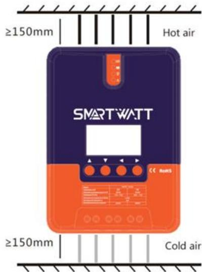
Рисунок 5. Установка и рассеивание тепла
