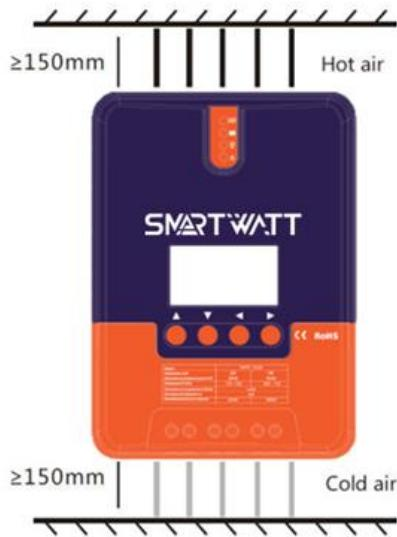
Рисунок 5. Установка и рассеивание тепла
